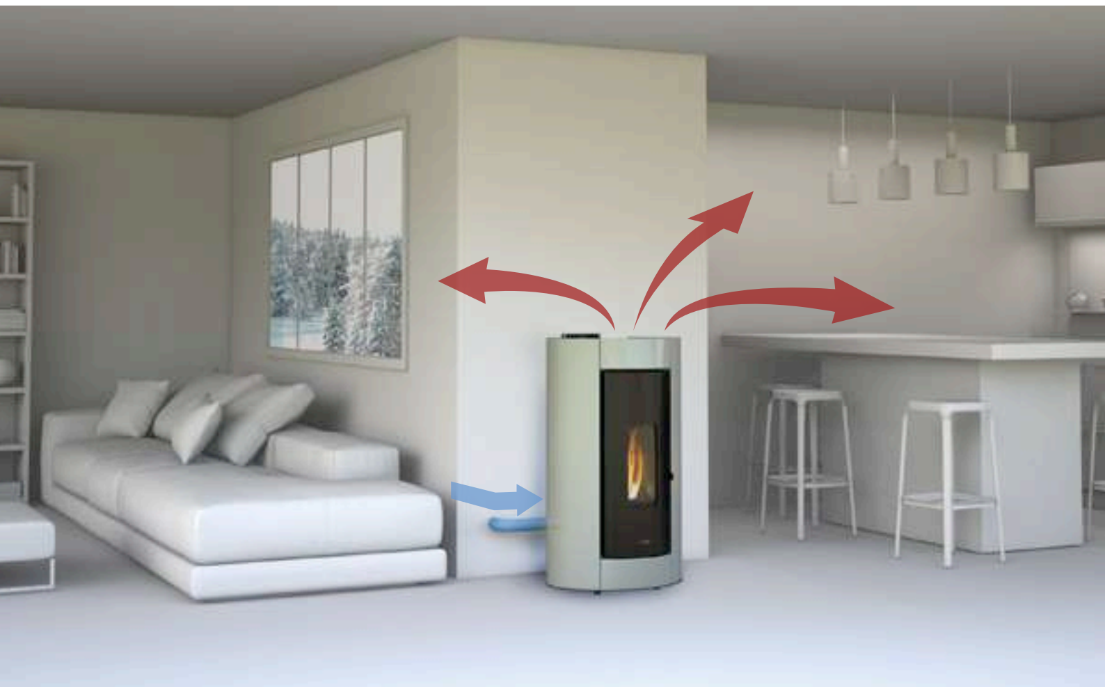
ESEMPIO INSTALLAZIONE STUFA CON CAMERA STAGNA Example of installation of a stove with a sealed chamber / Exemple d'installation poêle étanche Installationsbeispiel eines Ofens mit abgedichteter Kammer
